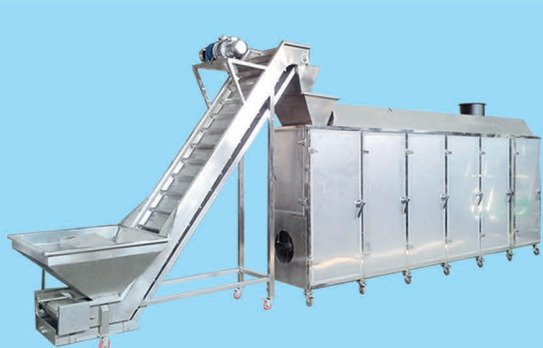
自然风多层风干流水线
